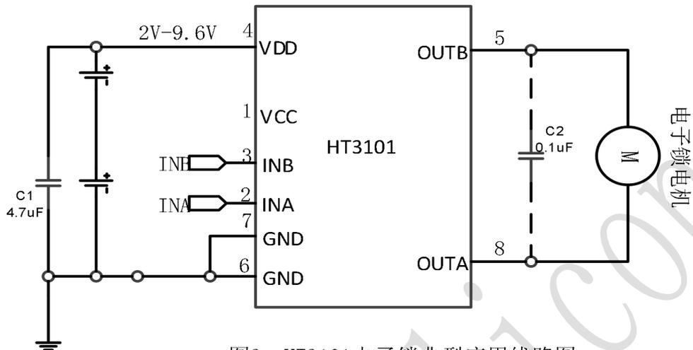
图3 HT3101电子锁典型应用线路图
